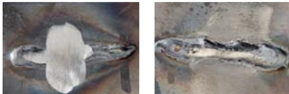
Bearbeitungsunterschiede: Links Bearbeitung mit einer Schruppscheibe (spanabhebend), rechts mit einer Bürste (nicht spanabhebend).
